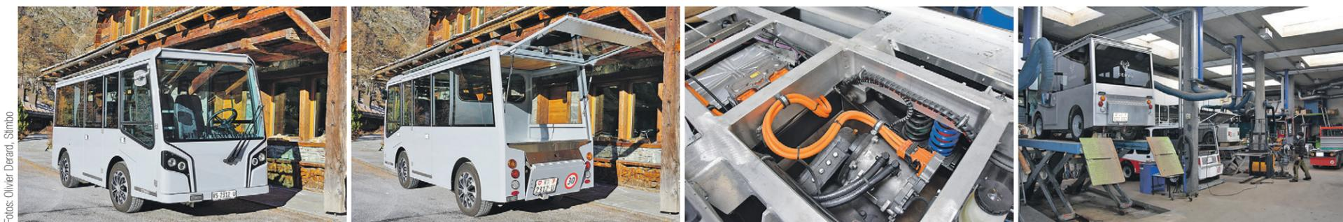
In einer garagengrossen Fabrik in Zermatt montiert Stimbo massgeschneiderte Fahrzeuge auf Aluminiumchassis.
