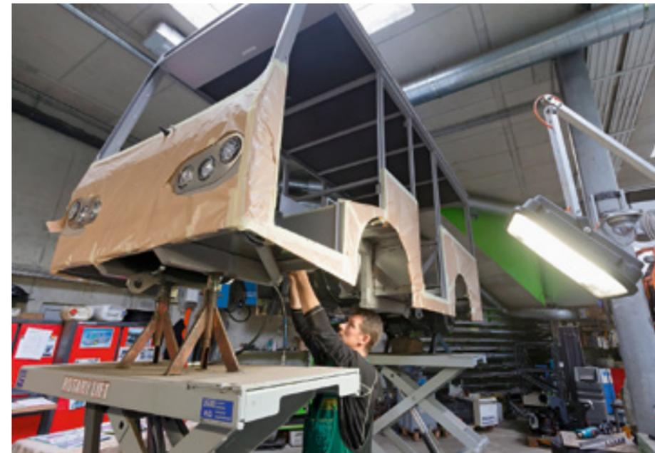
**E**in Niederflerbus für siebzig Personen mitsamt Skiausrüstung, 2,25 Meter breit, neun Meter lang, beladen dreizehn Tonnen schwer. Angetrieben von zwei Elektromotoren, luftgefedert. Das ist Bruno Imbodens Stolz.
