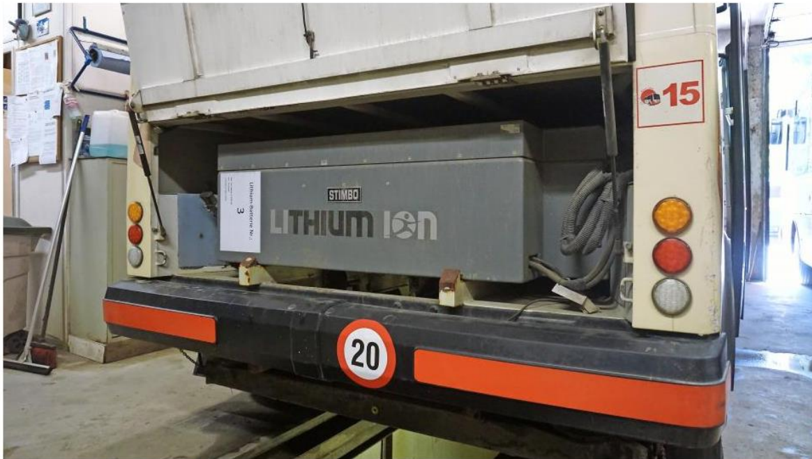
Die neue Technik: Lithium-Ionen-Batterien.
